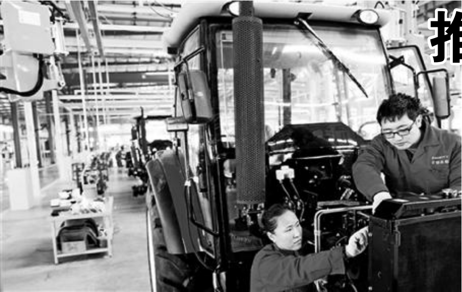
河北省邯郸市陶馆县锐特农机专注于国内中高端拖拉机及多品种复合式配套农机生产,整机实现在线电脑检测,生产的秧苗定位移栽机、自动立体覆膜机将填补国内空白。图为员工正在组装拖拉机配件。
